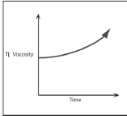
Fig. 8B: Viskositetskurve for en rheopeks væske
