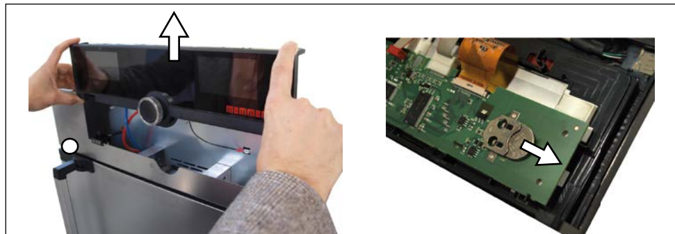
Fig. 25 Fjernelse af litumbatteri
