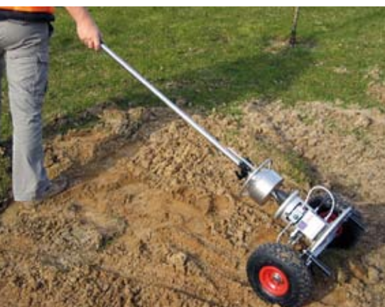
PRIMA100 LWD transporteres fra målepunkt til målepunkt på trolley.
